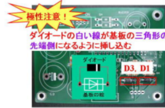
手順5: ショットキーダイオードD1, D3 (足にテープが付いている大きい方のダイオード)
