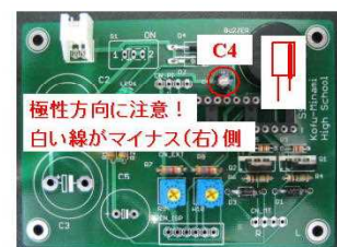
14 C4 47μF 極性方向に注意! コンデンサの白い線をマイナス側
