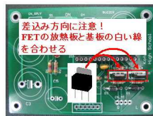
10 Q1, Q2 差し込み方向に注意! 図のようにFETの放熱板が基板の白い線側
