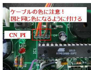
20 CN_PI センサケーブル(橙赤茶黒の順に 橙が基板の“CN_PI”の“C”側)
