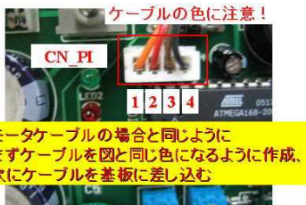
24 センサケーブルを作成し、基板に接続 橙が1 赤が2 茶が3 黒が4
