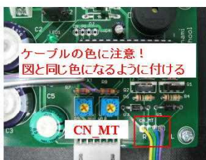
19 CN_MT モーターケーブル(黄緑青紫の順に 黄が基板の“R”側、紫が“L”側)
