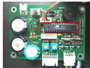
25 ICを足を折れないようにソケットに差し込む
